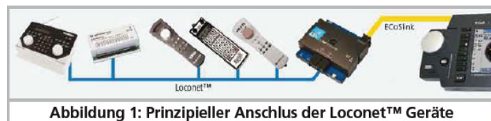
Illustration 1 : raccordement de principe des périphériques LocoNet™.
