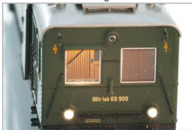
Illustration 2 : éclairage de la cabine.
