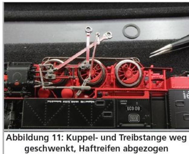
Fig. 11 : Déconnecter l'embrayage et la tige d'entraînement, retirer les bandes
