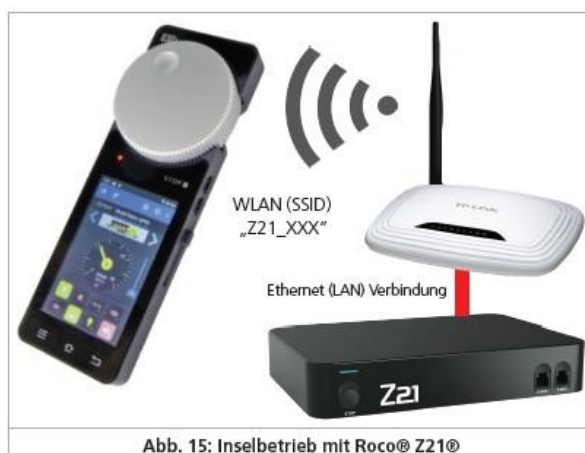
Abb. 15: Inselbetrieb mit Roco® Z21® Afb. 15 aansluiten Roco®Z21
