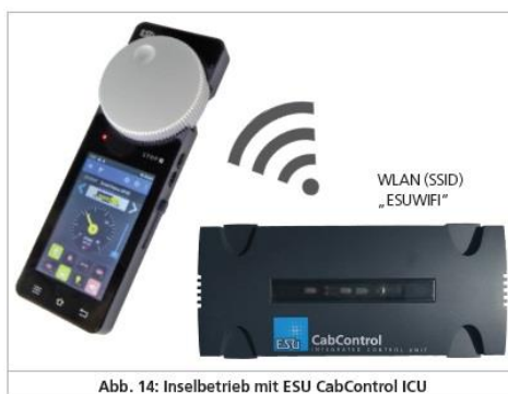
Abb. 14: Inselbetrieb mit ESU CabControl ICU Afb. 14 aansluiten op CabControl (draadloos)
