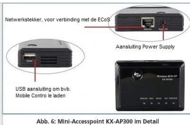
Afb. 6 Mini Access point in detail
