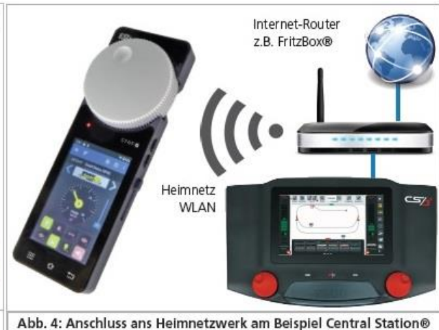
Afb.4 Aansluiting op het thuisnetwerk aan de hand van de Central Station®
