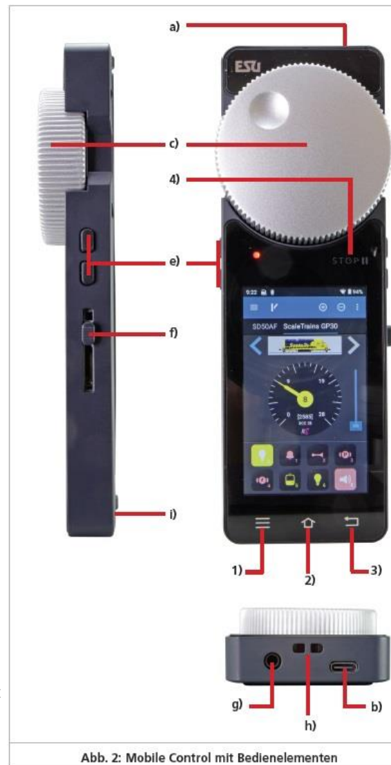
Abb. 2: Mobile Control mit Bedienelementen
