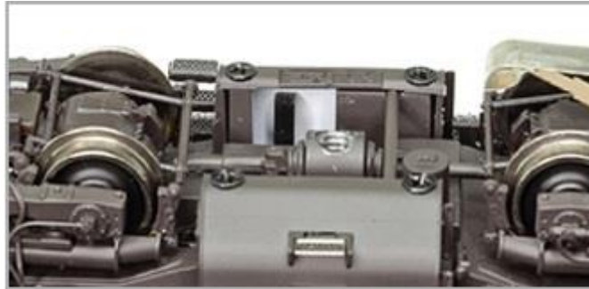
Abbildung 3: Schiebeschalter auf AC-Betrieb
