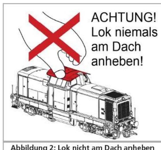
Figure 2 : Ne pas soulever la locomotive par le toit
