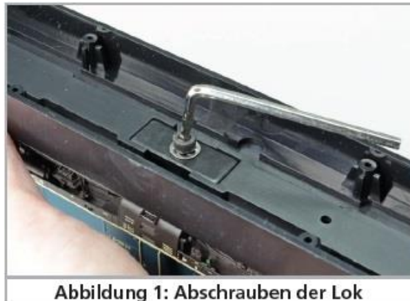
Figure 1 : Dévissage de la locomotive
