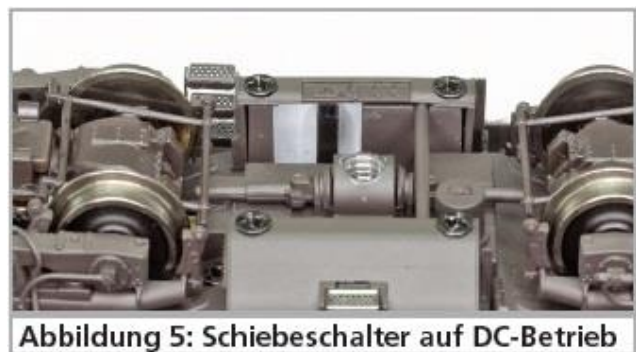
Fig. 5: Interrupteur en mode DC
