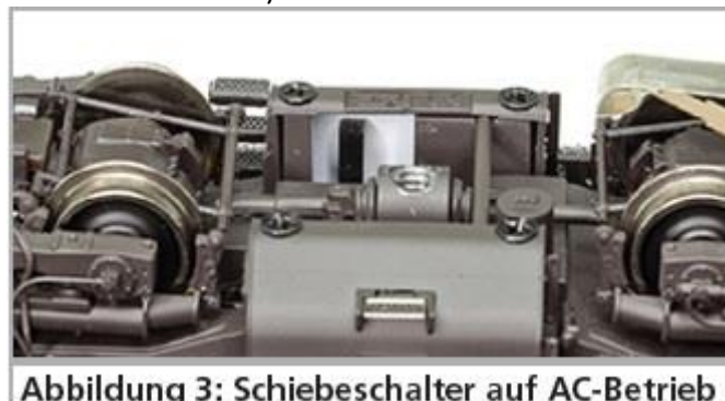
Afbeelding 3: Schuifschakelaar naar AC-modus
