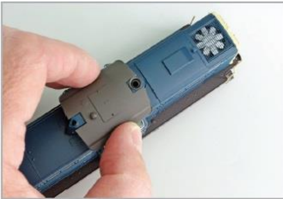
Abbildung 7: Abheben des Daches
