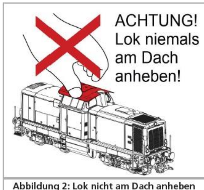
Figuur 2: Til de locomotief niet op aan het dak
