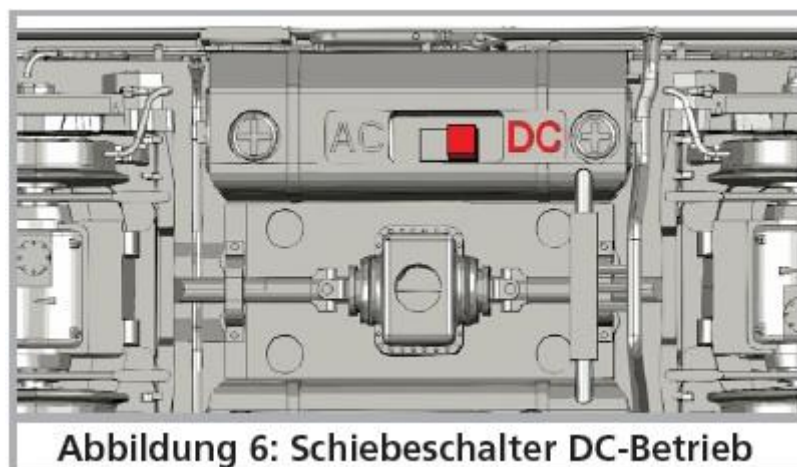
Figure 6 : Interrupteur à coulisse en mode DC
