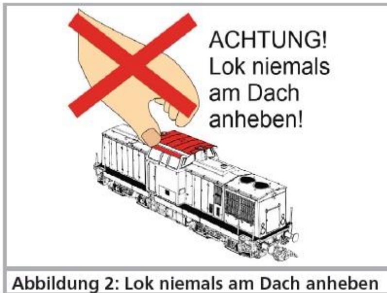
Figure 2 : Ne jamais soulever la locomotive par le toit.
